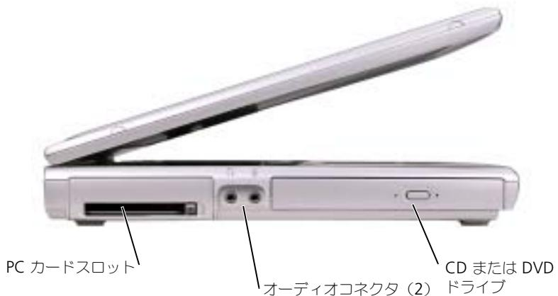
**PC カードスロット** — モデムまたはネットワークアダプタなどの PC カードを 1 枚サポートします。詳細に関しては、『Dell Latitude 100L ヘルプ』ファイルの「PC カードの使い方」を参照してください。ヘルプファイルにアクセスするには、14 ページを参照してください。
