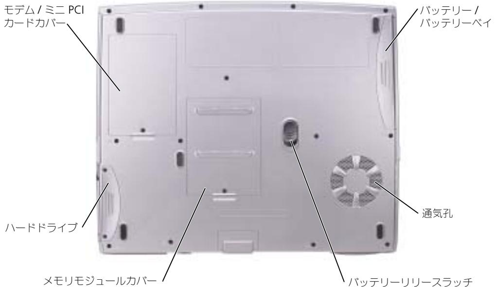
**モデム / ミニ PCI カードカバー** — モデムとミニ PCI カードのコンパートメントのカバーです。75 ページを参照してください。
