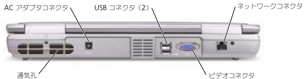
**通気孔** — コンピュータは内蔵ファンを使って、通気孔から空気が流れるようになっています。これによって、コンピュータがオーバーヒートすることを防ぎます。
