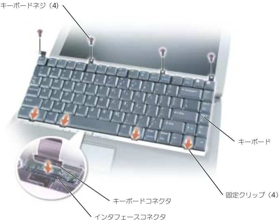
9 キーボード上の 4 つの固定タブを対応するパームレストのスロットに挿入し、キーボードをボトムケースに押し下げます。
